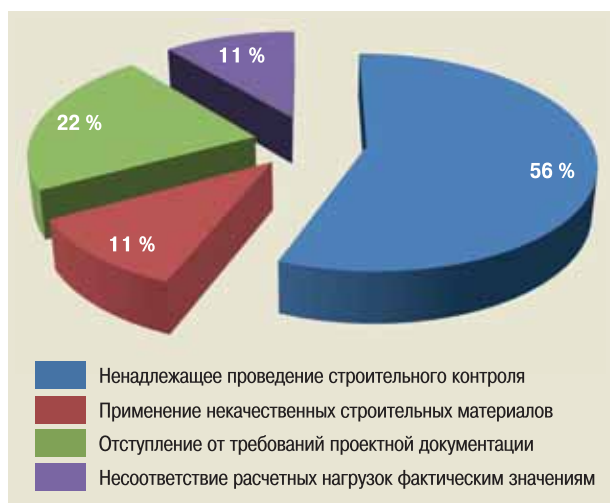
Рис. 53. Основные причины нарушения законодательства о градостроительной деятельности
